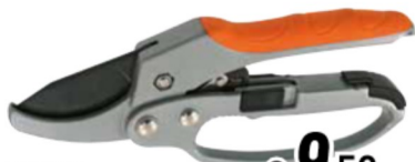
1486353 FORBICE DA POTATURA CON CRICCHETTO TAGLIO BATTENTE Lunghezza 200mm. Lame in acciaio temprato rivestite al teflon. Capacità di taglio su legno verde: 27mm.
